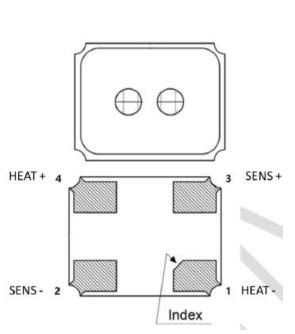
FIGURE 2. PIN CONFIGURATION
